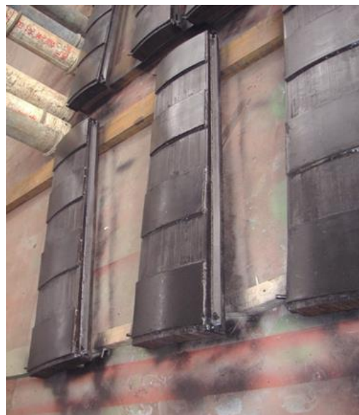
Рис. 4. Магнитные стержни в демонтированном виде
