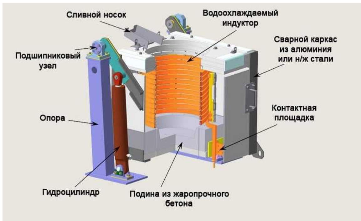
Рис. 2. Устройство индукционной плавильной печи
