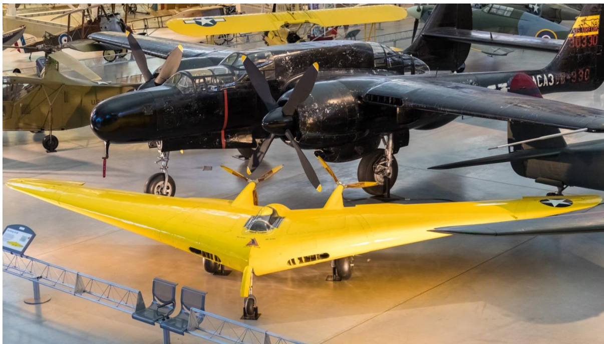
Рис. 8. Самолет конструкции «летающее крыло» и P-61, в котором применялись аэродинамические щитки вместо элеронов
